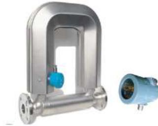
Измерение массового расхода, температуры и плотности. Диаметр: 50 мм. Максимальная скорость расхода: 60 т /ч (1000 кг/мин). Максимальное рабочее давление — 4 МПа. Защита: IP65/ IP67. Температура жидкости: -70°C~+160 °C, -200 ~ + 60°C, -40 ~ + 300°C. Выход: RS485 Modbus RTU, HART, 4-20 mA, импульсный. Смачиваемые материалы: Нержавеющая сталь 316L
